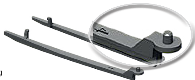
CAD-Abb. zeigt geänderte Weichenzunge
