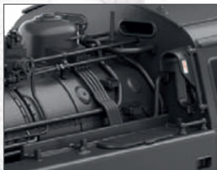
Detailreich ausgestatteter Kessel, mit vielen angesetzten Leitungen
