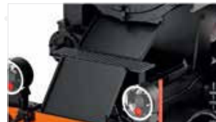
Schütte unter der Rauchkammertüre
