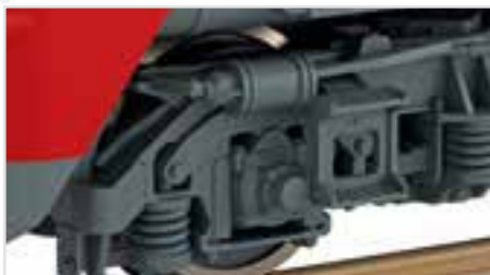
Bremszylinder detailliert ausgeführt
