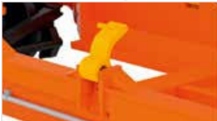
Klappriegel beweglich für Transport von Containern
