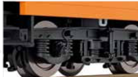
Vorbildgerechte Drehgestelle der Bauart Görlitz V modifiziert
