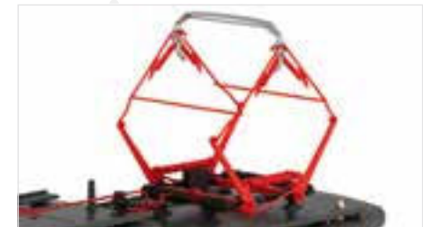
Stromabnehmer SBS 10 aufwendig umgesetzt und unsichtbar befestigt
