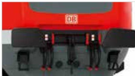
Aufwendig zugestützte Pufferbohle
