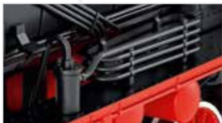
Aufwendig nachgebildeter Luftrockner mit Ölabscheider
